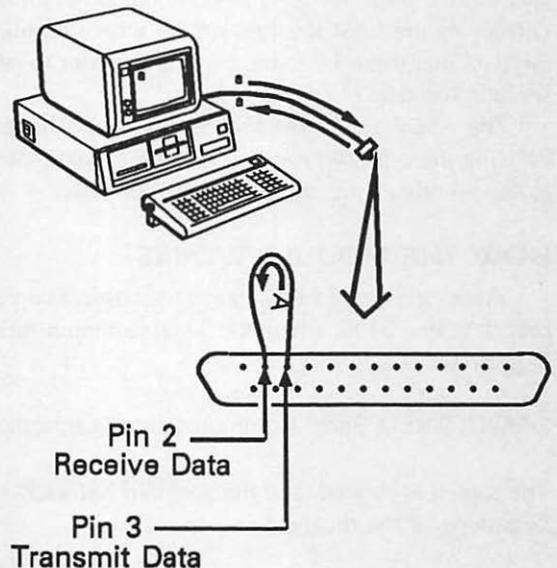
Fig. 6-8. Loopback diagram.
