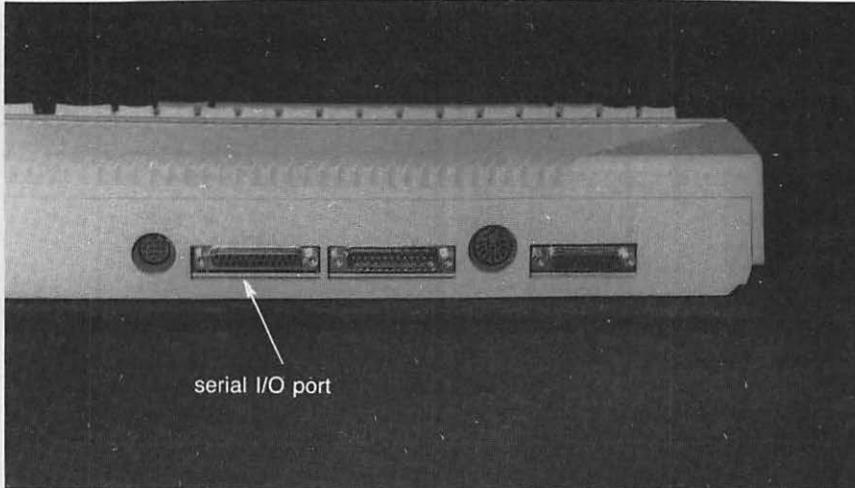
Fig. 4-7. Serial I/O port.
